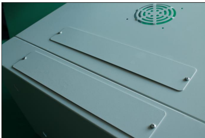
Przepusty kablowe w tylnej części
