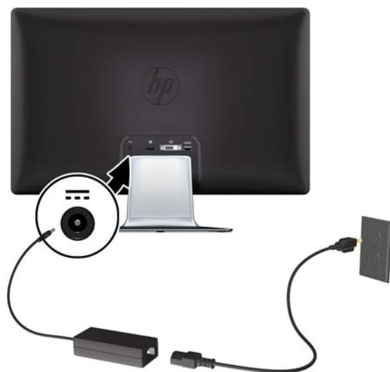
Rysunek 3-6 Podłączanie kabla zasilania
