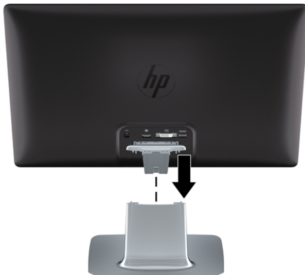
Rysunek 3-2 Wkładanie panelu monitora
