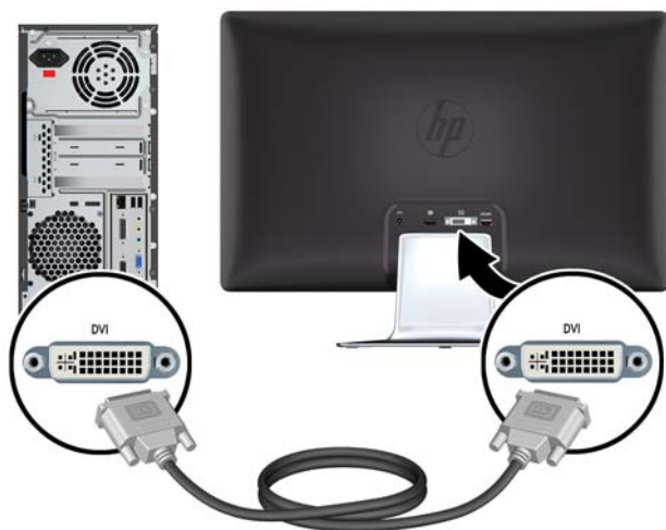
Rysunek 3-3 Podłączenie kabla DVI-D
