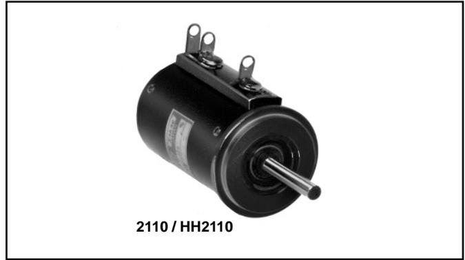
Die Potentiometer der Serie Servopot sind qualitativ hochwertige Bauelemente mit guten elektrischen Werten und in solider Bauweise mit 2fach kugelgelagerter Welle. Diese Serie wurde speziell entwickelt für Nachlaufsysteme, Motorpotentiometer und Servoanwendungen. Das HYBRID-Servopot ist durch seine Technologie "Leitplastikschiicht auf Drahtelement" besonders geeignet für schreibende Meßgeräte und ähnliche Anwendungen, bei denen es auf extrem feine Auflösungen bei hoher Lebensdauer ankommt.
