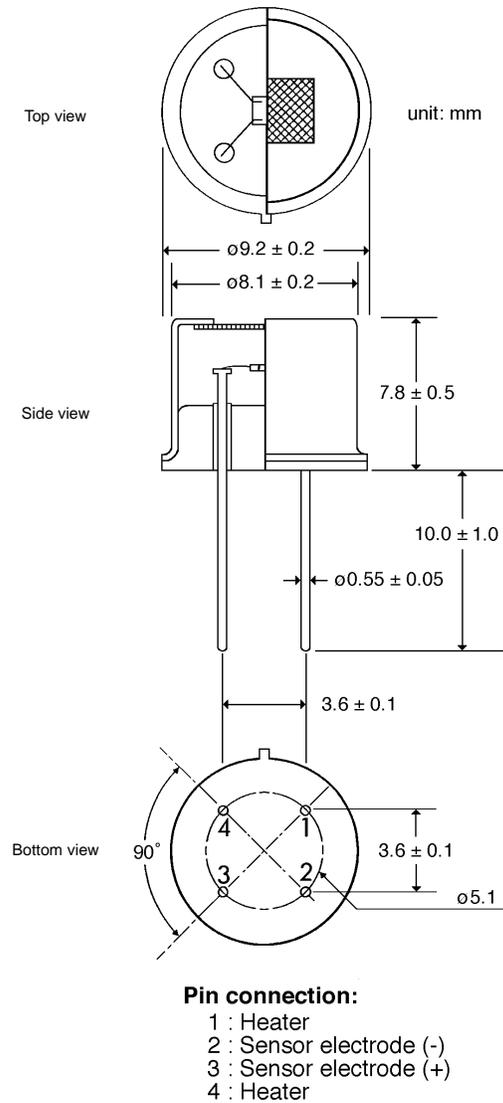
Fig. 3 - Sensor dimensions
