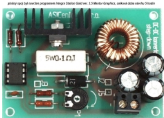
Obr.12 Fotografie osazeného modulu konvertoru “step down”
