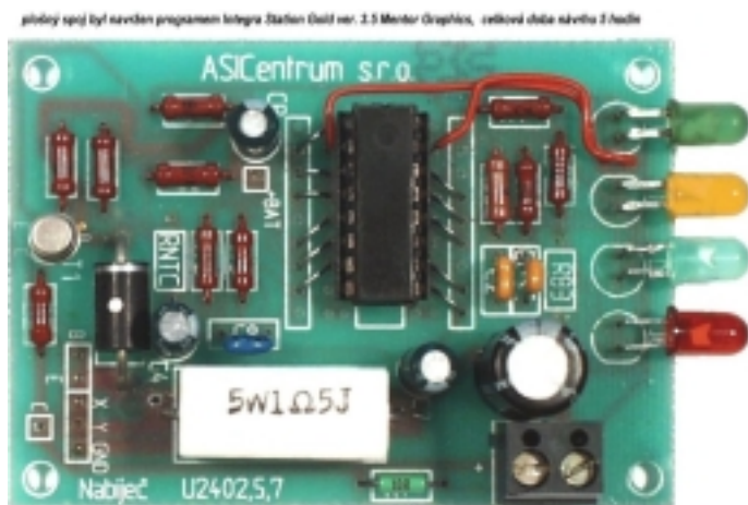
Obr.13 Fotografie osazeného modulu nabíječky s U2407B
